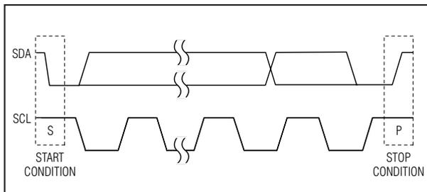
图3. 启动条件和停止条件
