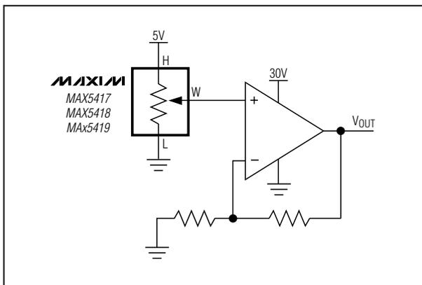
图 9. 用分压器实现 LCD 正偏调节
