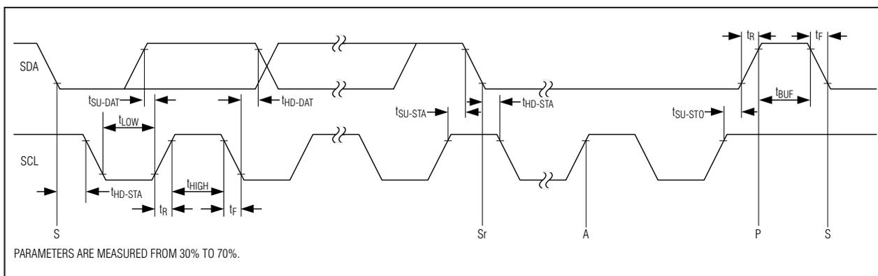
图1. I<sup>2</sup>C串行接口时序
