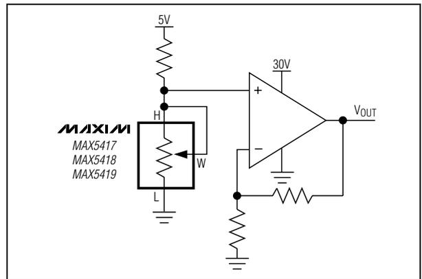
图 10. 用可变电阻实现 LCD 正偏调节
