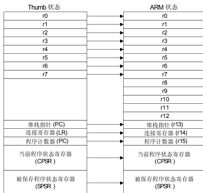
图 2-5 Thumb 寄存器在 ARM 状态寄存器上的映射
