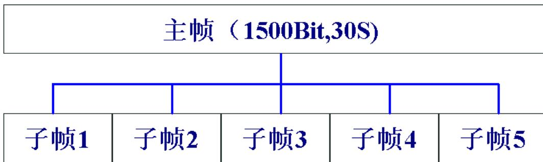
上图标示了 GPS 导航电文的基本内容,下面逐一叙述各子帧的导航信息:
