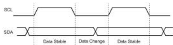
图 3 在 SDA 总线上有效的数据变化
