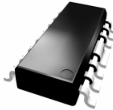
S3C 16 Pin SOIC Package
