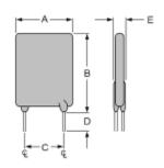
FRV 005-240F~FRV016-240F Lead Size: 24AWG Φ 0.51 mm Diameter
