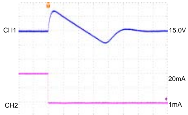
1msec/div CH1:Vout1 , AC-COUPLED, 200mV/div CH2:Iout1 , 10mA/div
