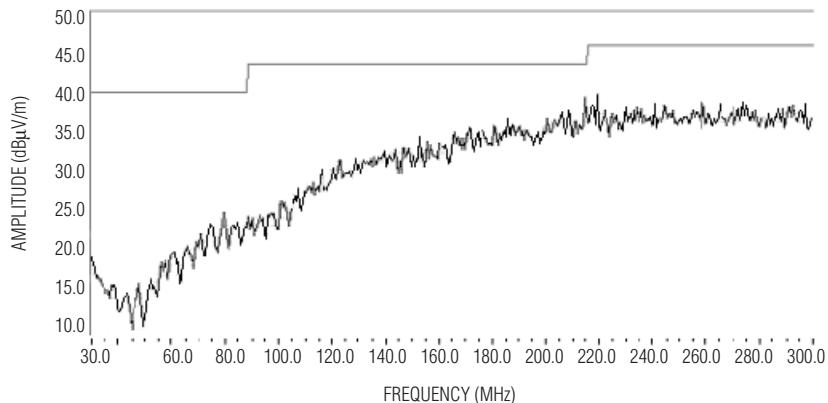
图 3. 75mm 扬声器电缆传输时的 MAX9770 EMI
