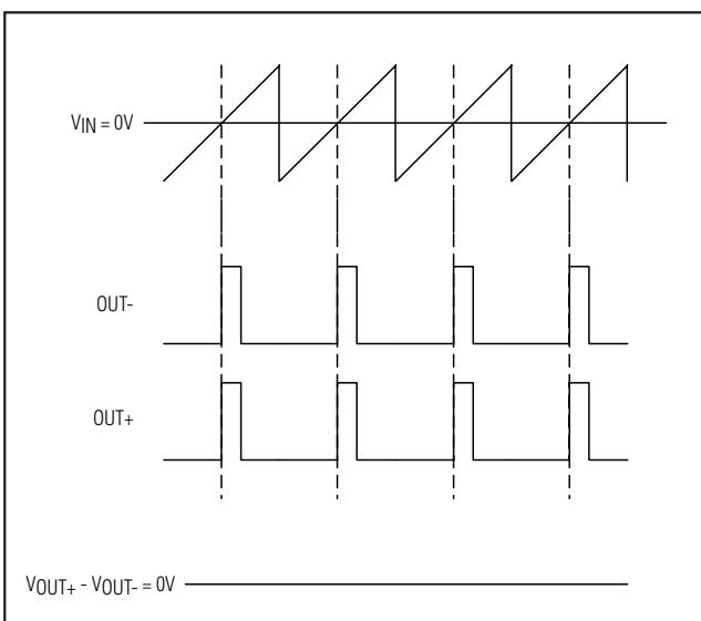
图 4. 无输入信号时 MAX9770 的输出
