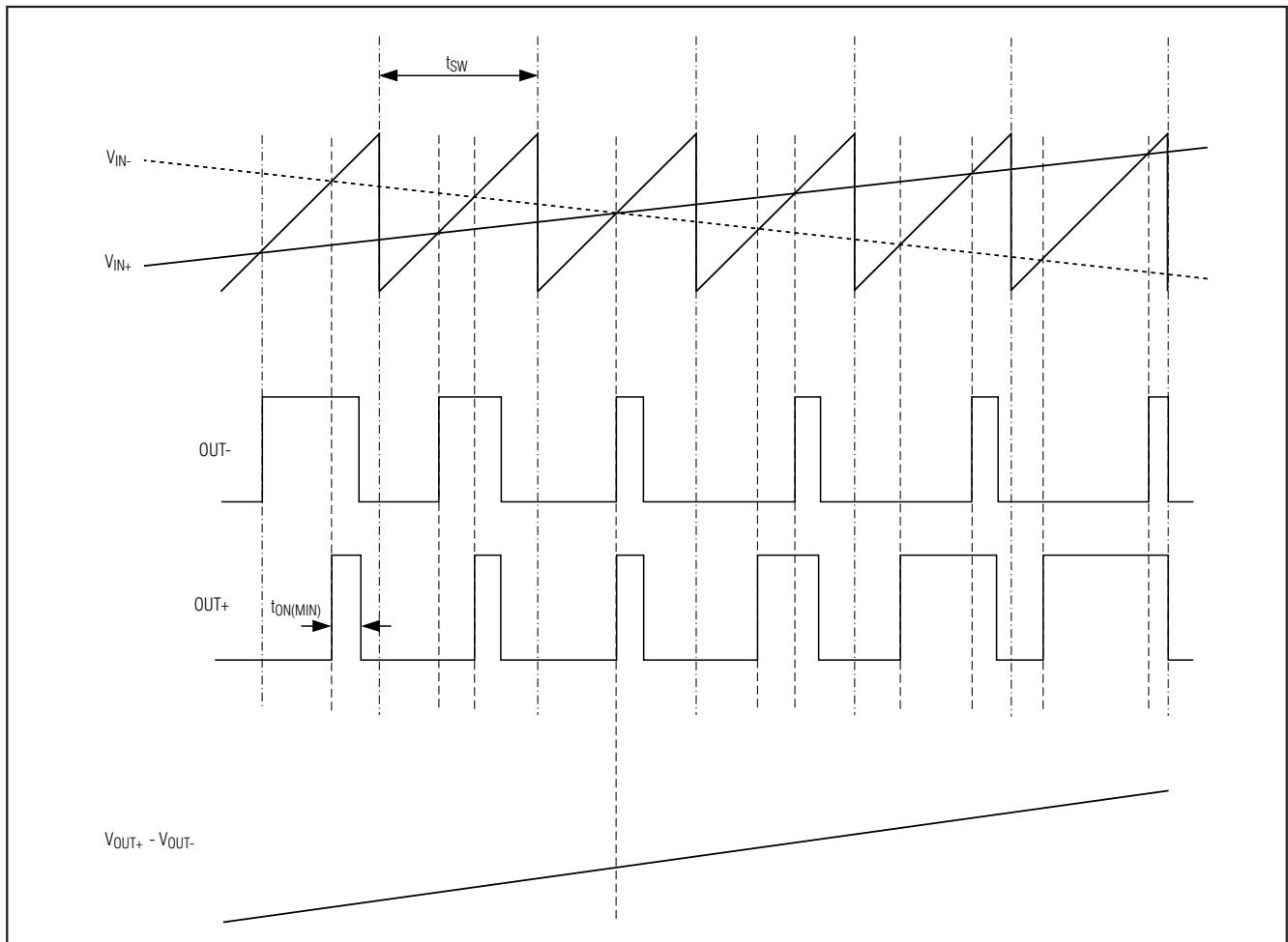
图1. 输入单路信号时 MAX9770 的输出
