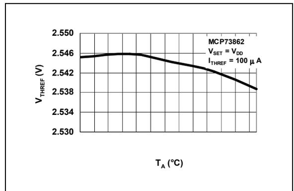
图 2-24: 热敏电阻参考电压 ( $V_{THREF}$ ) 与环境温度 ( $T_A$ ) 关系曲线
