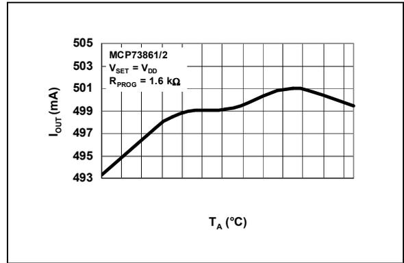
图 2-32: 充电电流 ( $I_{OUT}$ ) 与环境温度 ( $T_A$ ) 关系曲线
