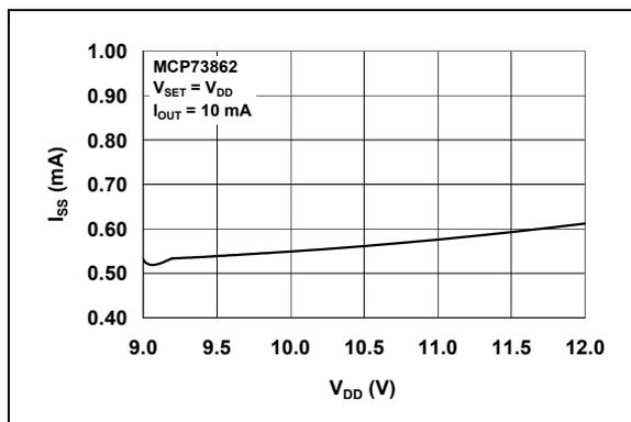
图 2-18: 电源电流 ( $I_{SS}$ ) 与电源电压 ( $V_{DD}$ ) 关系曲线
