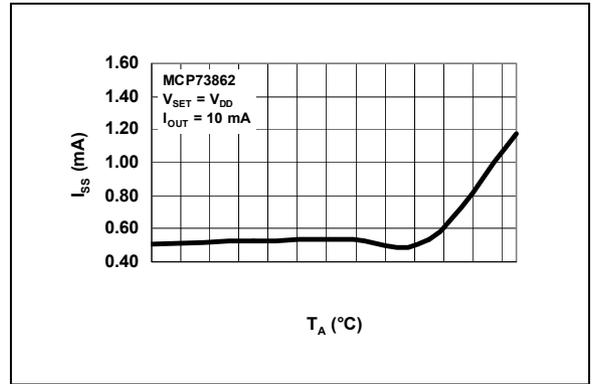
图 2-22: 电源电流 ( $I_{SS}$ ) 与环境温度 ( $T_A$ ) 关系曲线
