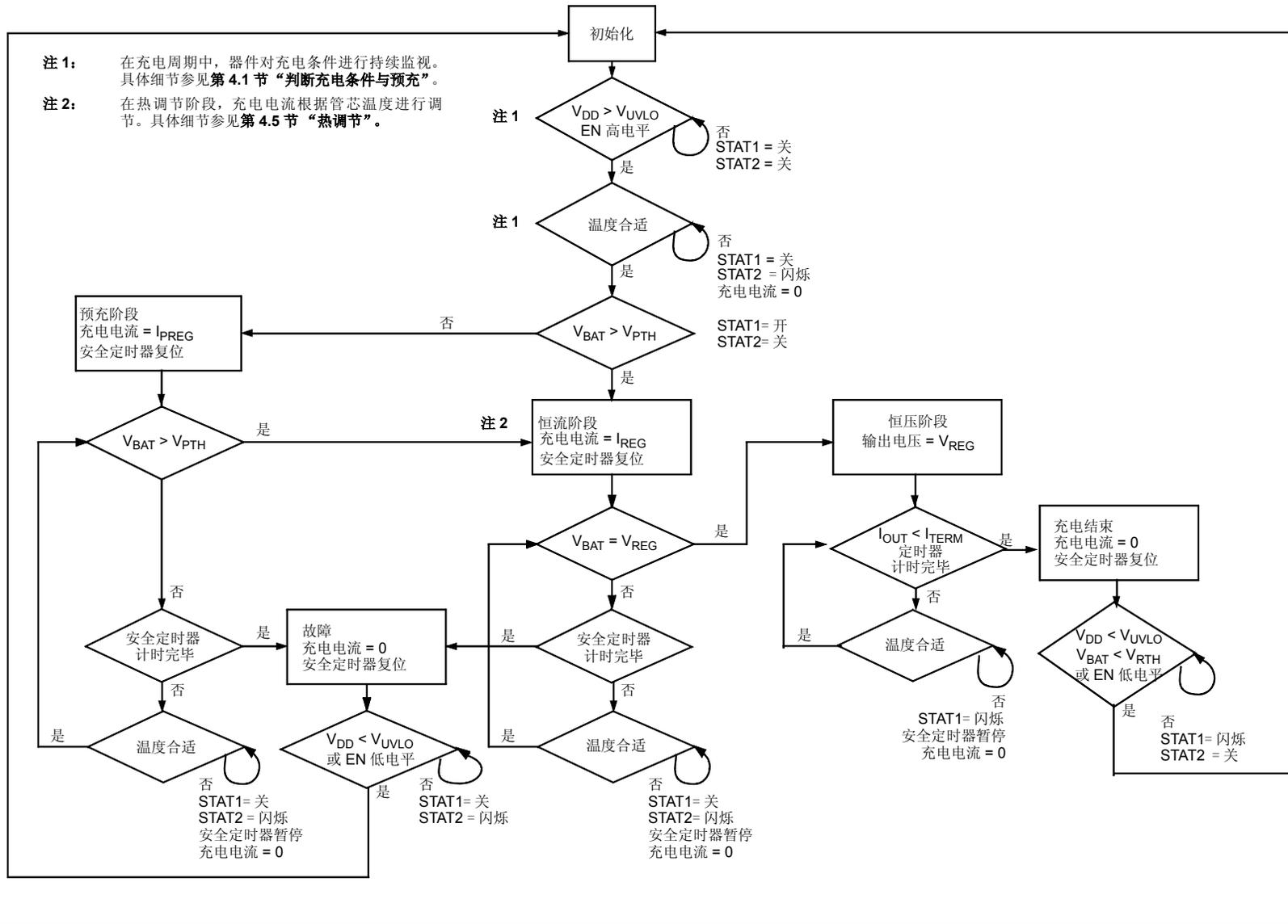
图 4-2: 操作流程算法
