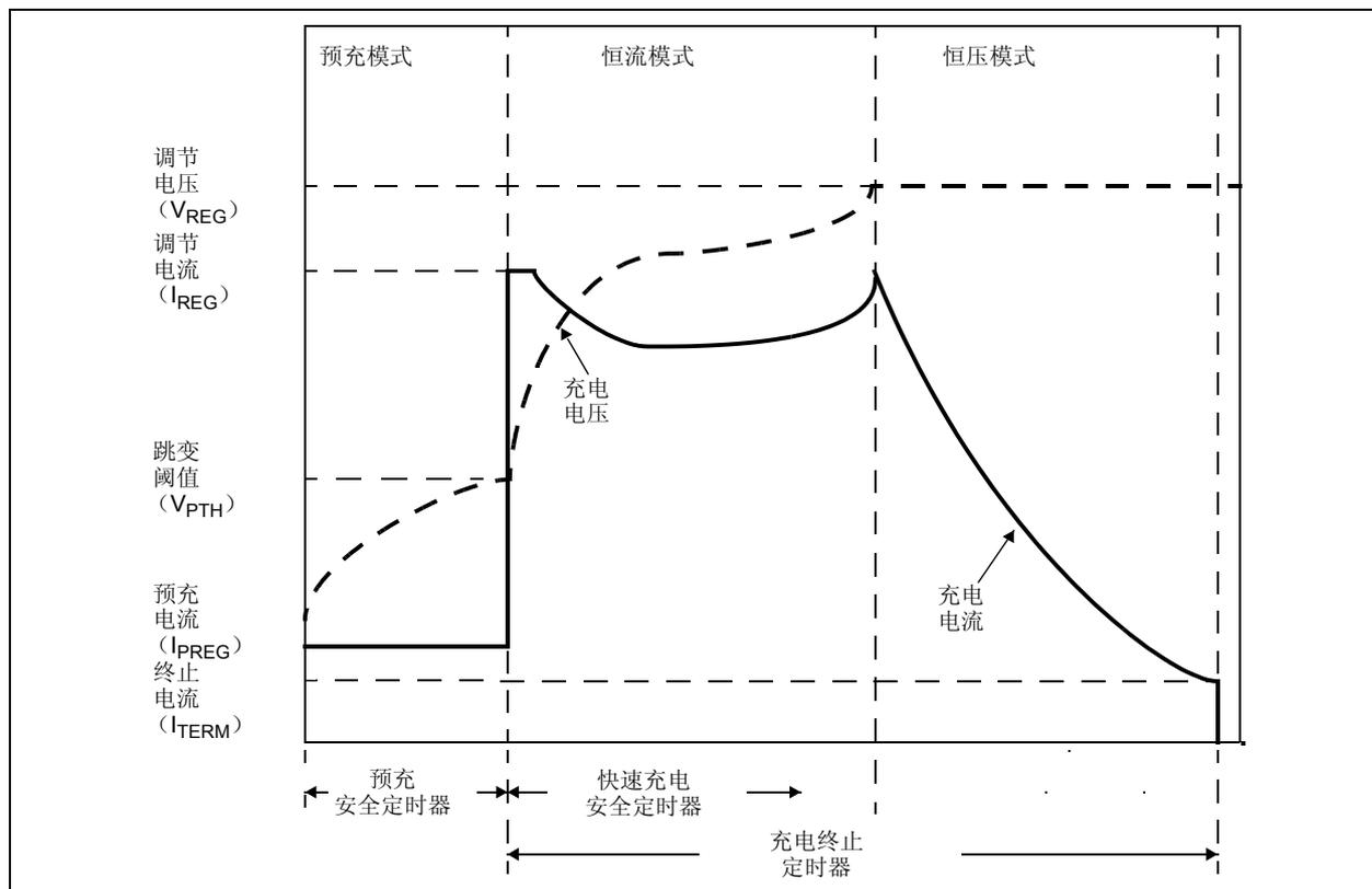
图 6-3: 具有热调节功能典型的充电曲线
