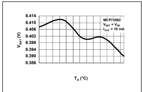
图 2-23: 电池调节电压 ( $V_{BAT}$ ) 与环境温度 ( $T_A$ ) 关系曲线
