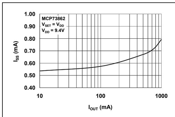
图 2-16: 电源电流 ( $I_{SS}$ ) 与充电电流 ( $I_{OUT}$ ) 关系曲线
