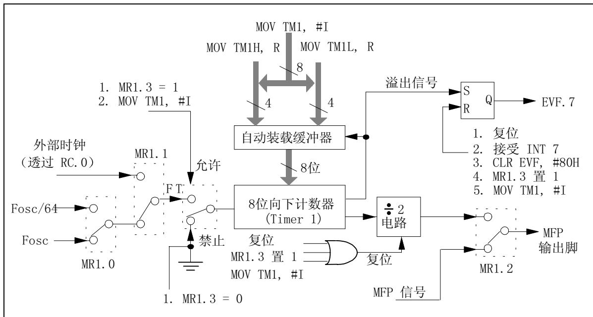
图6 定时器1的结构图
