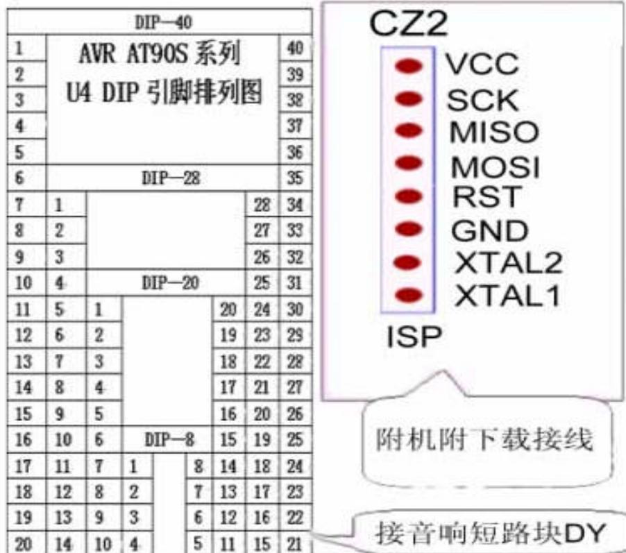
图 3.29 U4 对应 AVR 器件引脚及下载信号线名称
