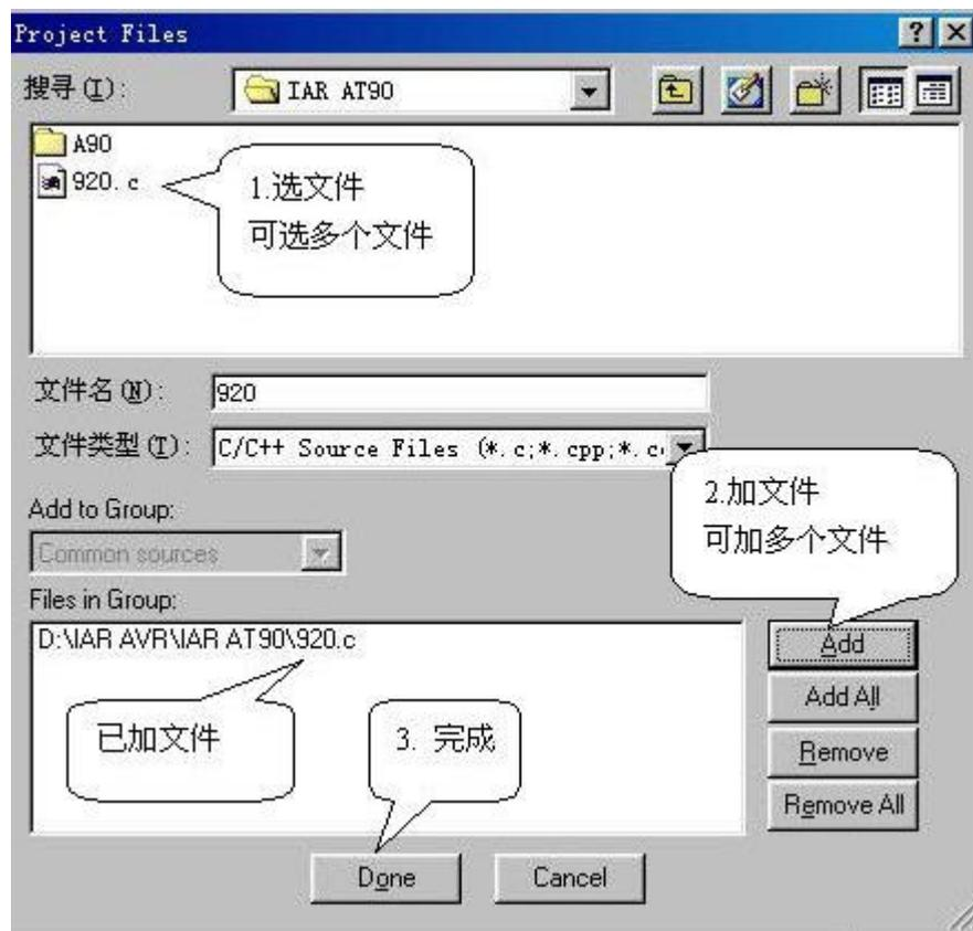
图 928 将源程序加入到工程文件
