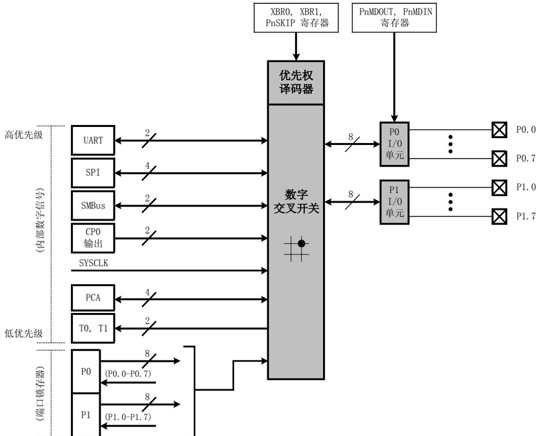
图 14.2 端口 I/O 单元框图
