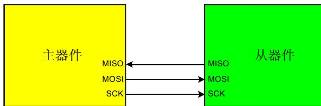
图 17.4 4线单主方式和4线从方式连接图
