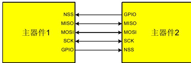
图 17.3 3线单主方式和3线单从方式连接图
