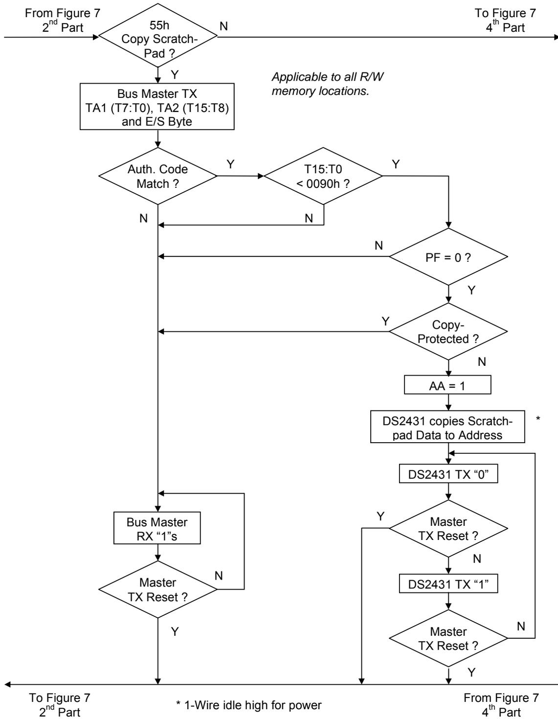
图 7-4. 存储器功能流程图 (续)
