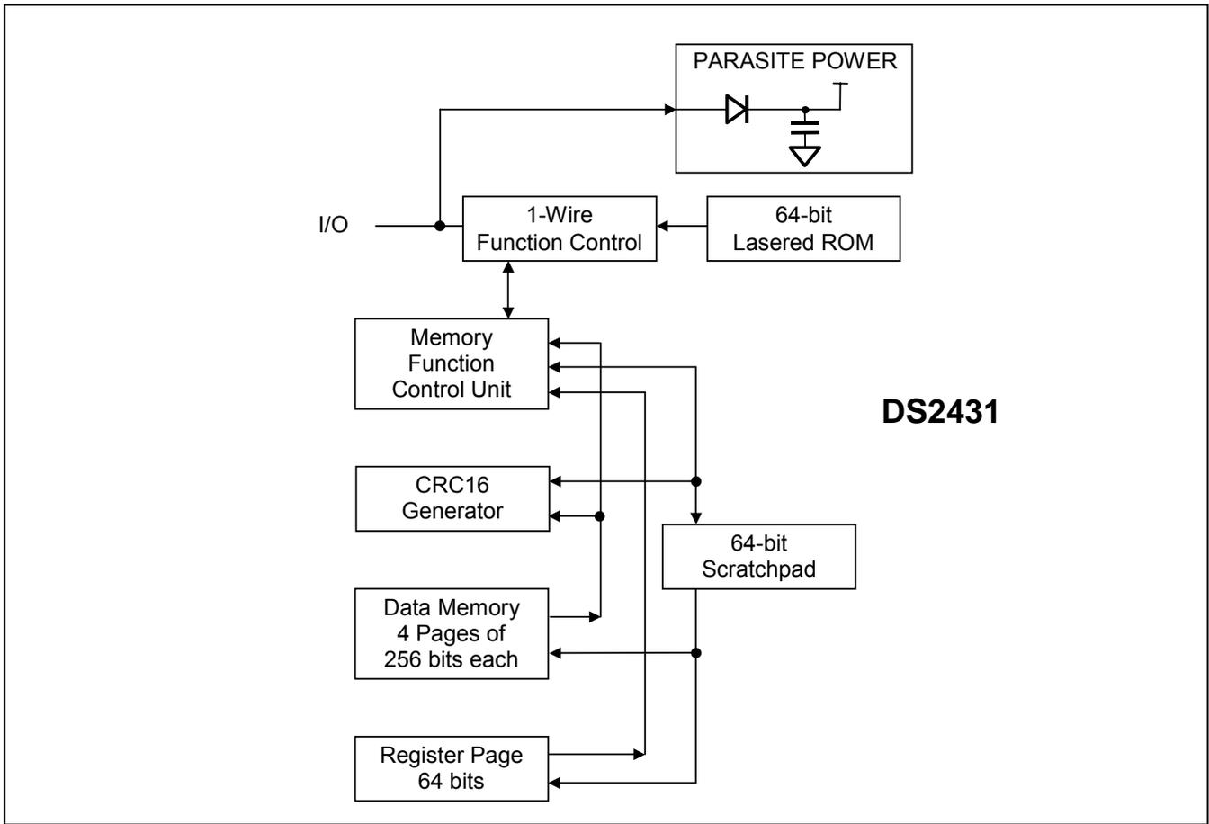
图 2. 1-Wire 协议层次结构图
