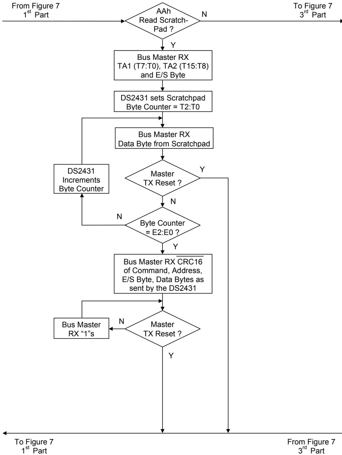
图 7-3. 存储器功能流程图 (续)
