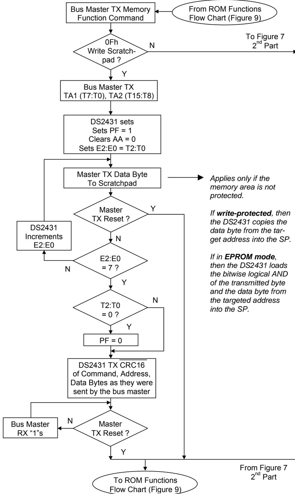
图 7-2. 存储器功能流程图 (续)
