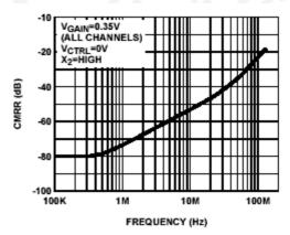
FIGURE 11. COMMON-MODE REJECTION
