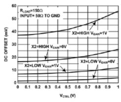
FIGURE 9. OFFSET vs V<sub>CTRL</sub>
