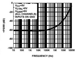
FIGURE 13. (+)PSRR vs FREQUENCY
