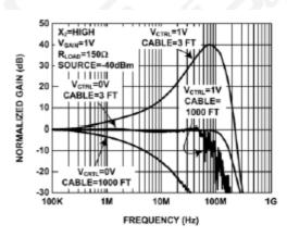
FIGURE 5. GAIN vs FREQUENCY FOR VARIOUS V<sub>CTRL</sub> & CABLE LENGTHS
