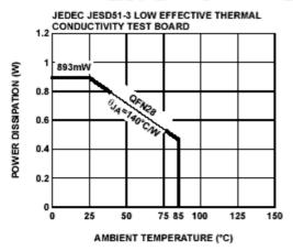
FIGURE 24. PACKAGE POWER DISSIPATION vs AMBIENT TEMPERATURE
