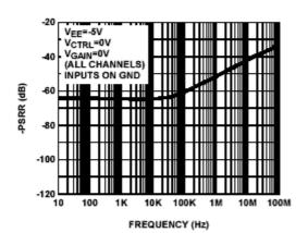
FIGURE 14. (-)PSRR vs FREQUENCY
