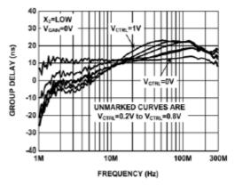
FIGURE 7. GROUP DELAY vs FREQUENCY FOR VARIOUS  $V_{CTRL}$
