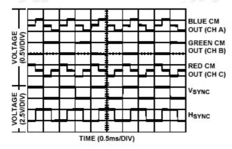
FIGURE 27. H & V SYNCS ENCODED
