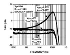
FIGURE 4. GAIN vs FREQUENCY FOR VARIOUS V<sub>CTRL</sub> & V<sub>GAIN</sub>
