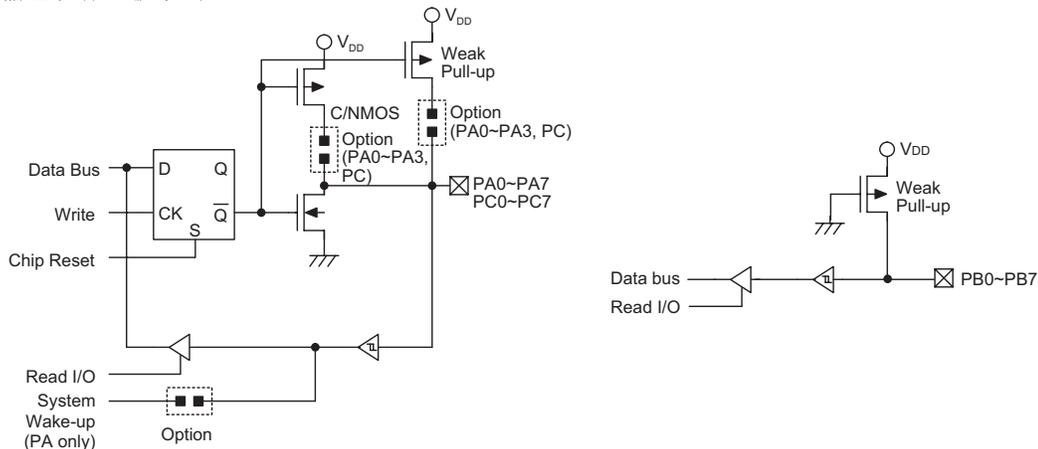
当 PA 和 PC 的结构为漏极开路 NMOS 型时，必须要注意：从引脚读数据前，应该先写“1”到相关位来禁止 NMOS 器件。既首先执行“SET[m].i”(i=0~7 仅对 PA 而言)来禁止相关位的 NMOS 器件，然后“MOV A, [m]”来获得稳定的数据。
