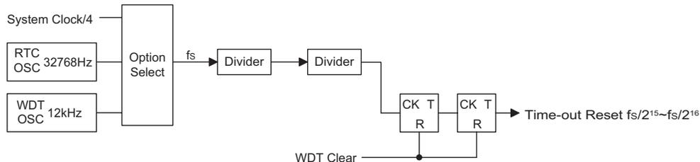
如果 WDT 时钟源为内部 WDT 振荡器的话，那么溢出时间会因为温度、 $V_{DD}$  以及芯片参数的变化而变化。如果选择了指令时钟为时钟源，在 HALT 状态时，WDT 会停止计数而失去保护功能。只能由外部逻辑来重新启动系统。因此若单片机工作在干扰很大的环境中，强烈建议使用片内的 RC 振荡器（WDT OSC），因为 HALT 模式会使系统时钟停止运作。
