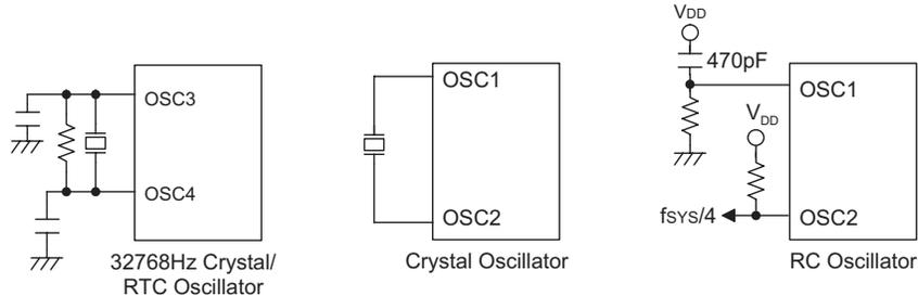
另外一种振荡电路被设计用于实时时钟（RTC）。在这种振荡电路中，只能用 32.768KHz 的晶体。晶体被连接在 OSC3 与 OSC4 之间。
