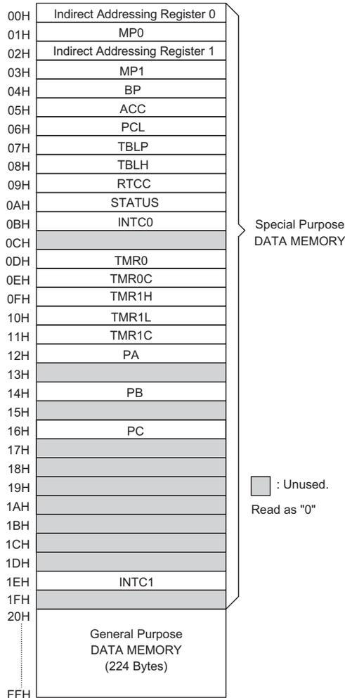
08H)，实时时钟控制寄存器（RTCC；09H），状态寄存器（STATUS；0AH），中断控制寄存器 0（INTC0；0BH），定时/计数器 0（TMR0；0DH），定时/计数器 0 控制寄存器（TMR0C；0EH），定时/计数器 1 高位寄存器（TMR1H；0FH），定时/计数器 1 低位寄存器（TMR1L；10H），定时/计数器 1 控制寄存器（TMR1C；11H），I/O 寄存器（PA；12H，PB；14H，PC；16H），中断控制寄存器 1（INTC1；1EH）。另外，通用数据存储器的 20H~FFH 地址作为程序数据和控制信息使用。
