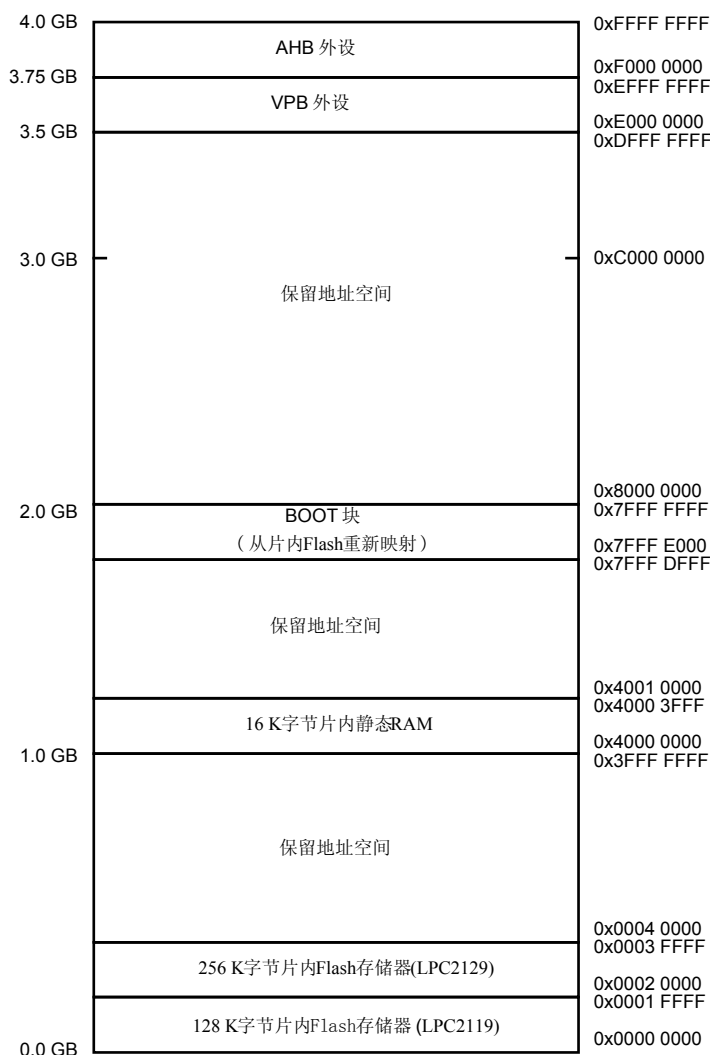
图3 LPC2119/2129 存储器映射
