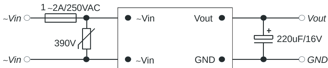
图 1-3 PS1000AC5SR 和 PS0300AC12SR 电源应用电路
