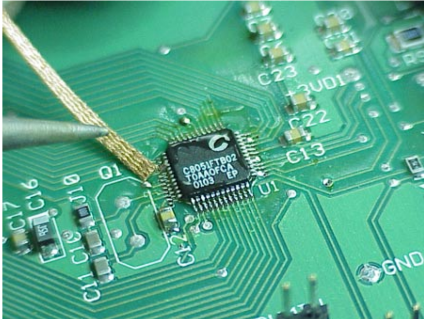
图 7. 涂焊剂；从引脚吸除焊锡
